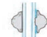
doucine (intérieur et extérieur) intérieur ◀ ▶ extérieur
