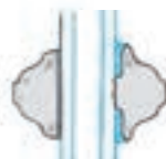
doucine (intérieur et extérieur) intérieur ◀ ▶ extérieur
